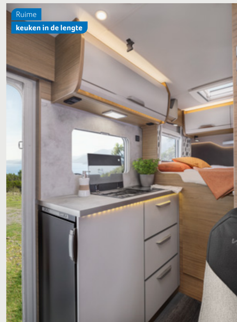
TOURER VAN 500 MQ. De ruime keuken biedt een goed georganiseerd keukenblok met aan de zijkant een compressorkoelkast, een 2-pits-kookplaat, een spoelbak en veel opbergruimte.
