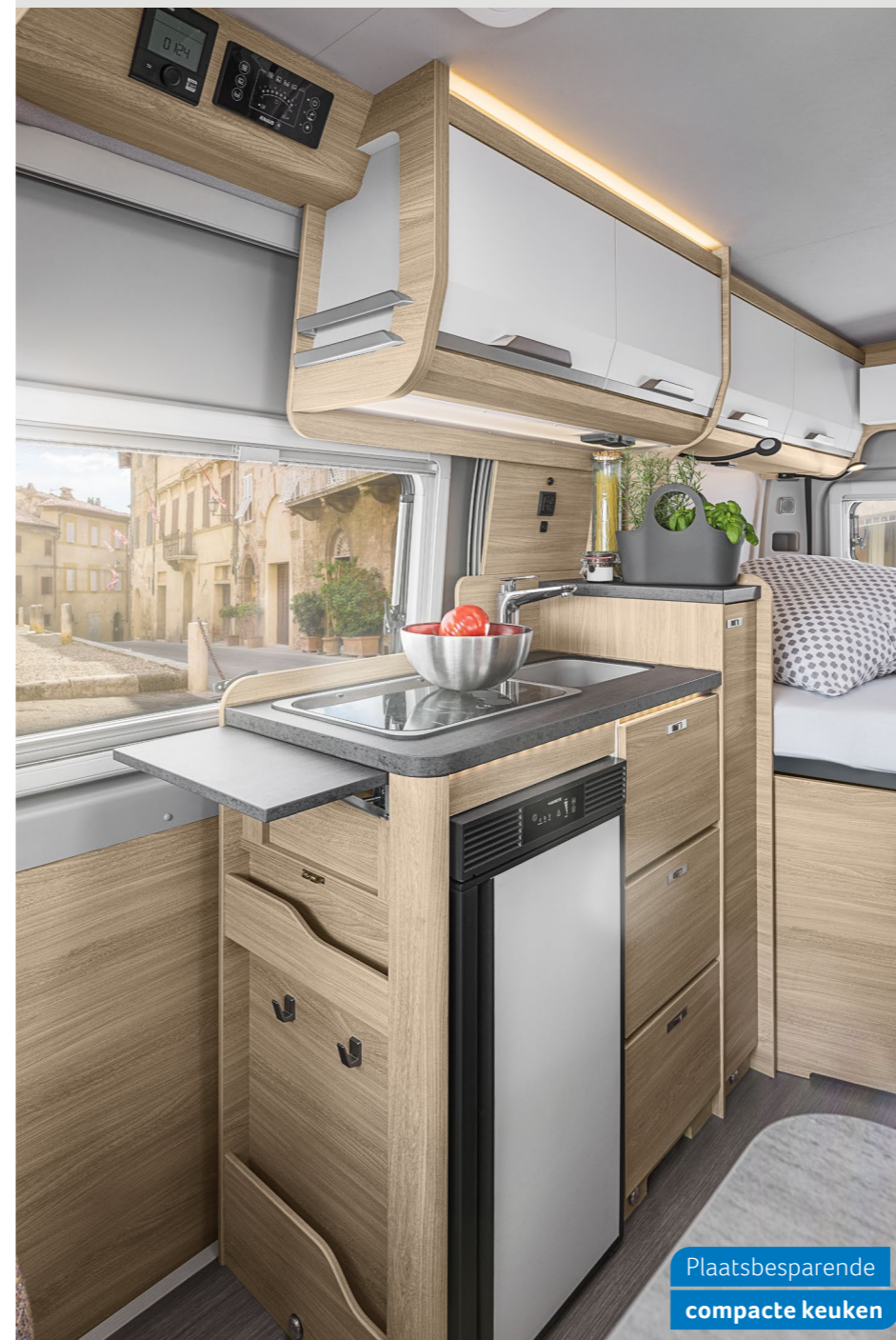
BOXLIFE PRO 630 FREEWAY. De keuken in de lengte biedt veel ruimte voor proviand dankzij de volledig uittrekbare laden, de bovenkasten en de koelkast. Praktische details zoals de uitklapbare werkbladverlenging zorgen voor een optimale gebruiksvriendelijkheid.
