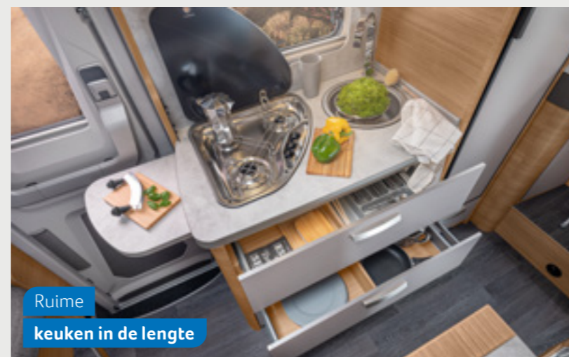
LIVE I 650 MEG. Dankzij inklapbaar werkbladverlengstuk hebt u een extra werkblad. De ruime schuifladen kunnen bijzonder ver worden geopend voor een gemakkelijke toegang dankzij de volledige uittrekfunctie.
