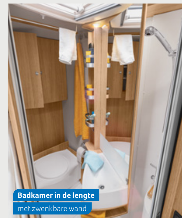
SKY TI 650 MF. Dankzij de zwenkbare wand kan de ruimte efficiënt worden benut. De wand kan heel makkelijk in de positie worden gezet die u net nodig heeft. Zo beschikt u met een kleine moeite over een ruime douchecabine of een royale wastafel.
