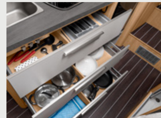
SKY TI 650 MEG. Schubladen mit kugelgelagertem Vollauszug. Fahren so weit heraus, dass sie bequem bis ganz hinten genutzt werden können.
