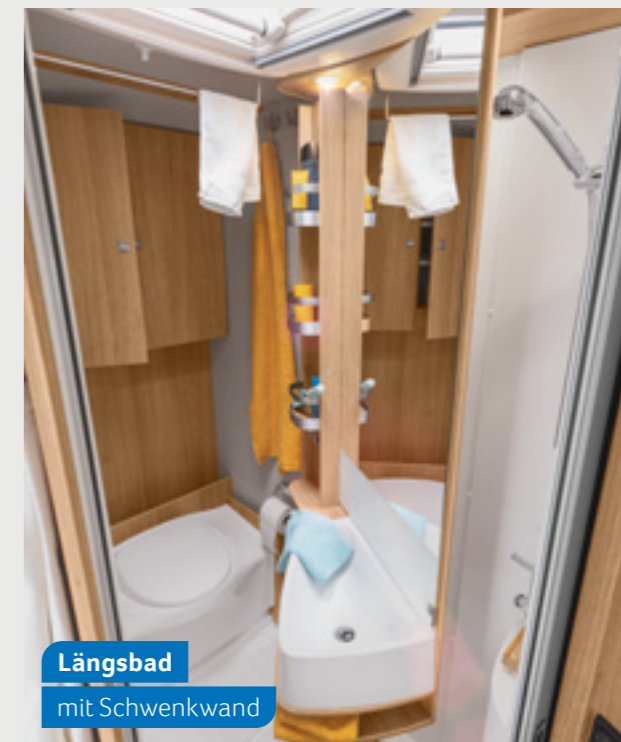
SKY TI 650 MF. Die Schwenkwand ermöglicht effiziente Raumnutzung und lässt sich ganz einfach in die Position stellen, die Sie gerade benötigen. So erhalten Sie mit einem Handgriff eine geräumige Duschkabine oder einen großzügigen Waschtisch.
