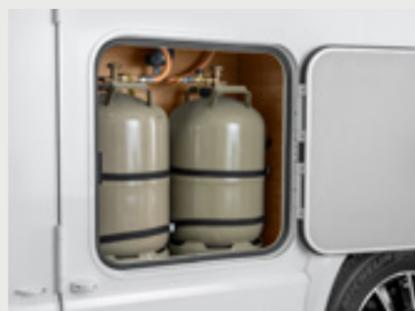
**Práctica caja de gas longitudinal.** Para facilitar el acceso y agilizar el cambio de las botellas de gas, instalamos una caja de gas longitudinal. Es adecuado para dos botellas de gas de 11 kg, que se encuentran una al lado de la otra (En todas las series).
