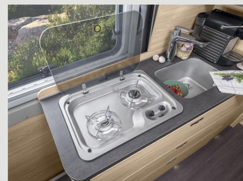
**BOXLIFE PRO 600 STREET.** Todos los modelos BOXLIFE PRO están equipados con una placa de dos fuegos dotada de una cubierta de vidrio. Gracias al encendido eléctrico, enseguida podrás empezar a cocinar.
