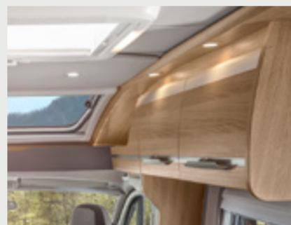
**Altillos.** Los altillos, de construcción sólida y robusta, no están en contacto directo con la pared: al montarlos se deja un espacio de separación. Así se evita la condensación de agua, de manera que la ropa y los objetos que contienen se mantienen siempre secos.
