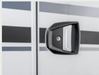
**Máxima seguridad.** Las modernas llaves con fresado interior se deslizan más fácilmente en la cerradura y, gracias a su superficie externa lisa, no se enganchan en los bolsillos de los pantalones (autocaravanas y CUV).
